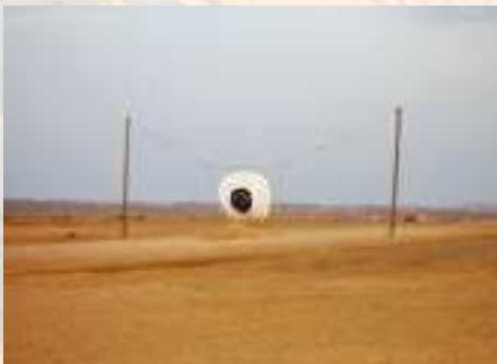
Ilustración 12. Blanco para ametrallamiento compuesto por un paracaídas, a modo de diana, y un micrófono que mide los impactos
